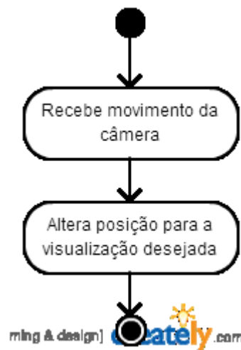
Figura 29. Diagrama de atividades: detalhamento do caso de uso Movimentar câmera.
