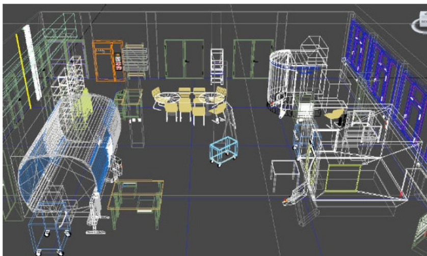
Figura 9. Exemplo de modelagem geométrica de um ambiente em RV (Yang; et al., 2011).
