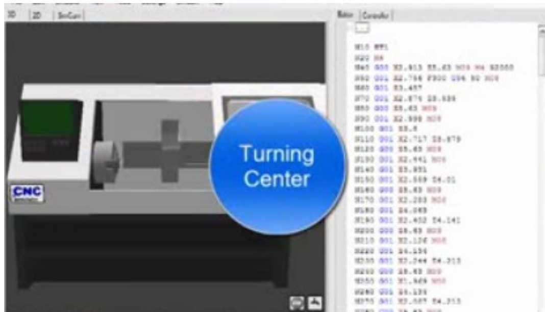
Figura 21. CNC Simulator Pro Turning Center, código G na lateral direita (CNCSimulator.com, 2013).
