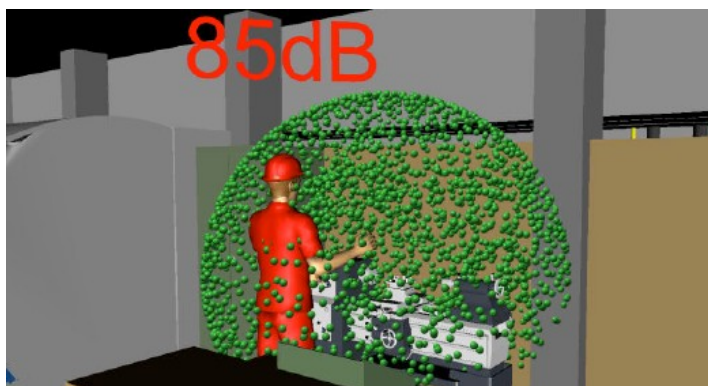
Figura 10. Simulação da propagação de som num torno virtual (Yang; Malak, et al, 2011).
